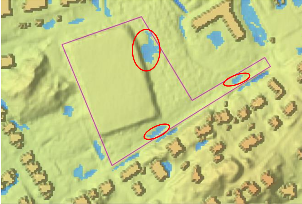
Figur 7. Vattenansamling i lågpunkter (röda ellipser) inom utredningsområdet (lilamarkerad) för befintlig situation vid 100-årsregn med klimatfaktor och varaktighet 10 minuter, vattendjupet är ca 0,15 m i de tre lågpunkterna inom utredningsområdet (SCALGO Live, 2020).
