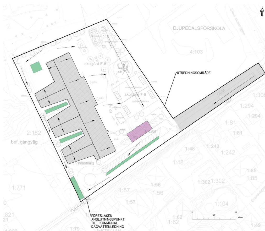
Figur 6. Avvattningsplan med föreslagna dagvattenanläggningar, regnbäddar i grönt och dagvattenmagasin i lila. Bakgrundskarta utgörs av Skanskas preliminära situationsplan. Föreslagen förbindelsepunkt till kommunalt dagvattennät är markerad i den sydvästra delen av utredningsområdet.
