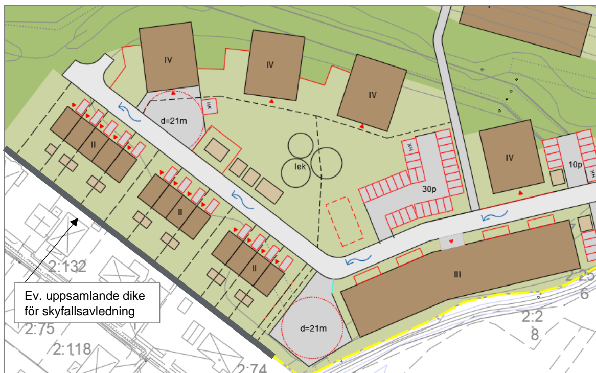
Figur 29. Föreslagen ytavrinning i det södra området. Genom att lägga gatan på en lägre nivå än närliggande hus och mark kan flöden styras och avledas vidare mot Hulebäcken. Ett uppsamlande dike i fastighetsgräns kan agera skyfallstråk vid extrema regn. (Källa: Härryda kommun)
