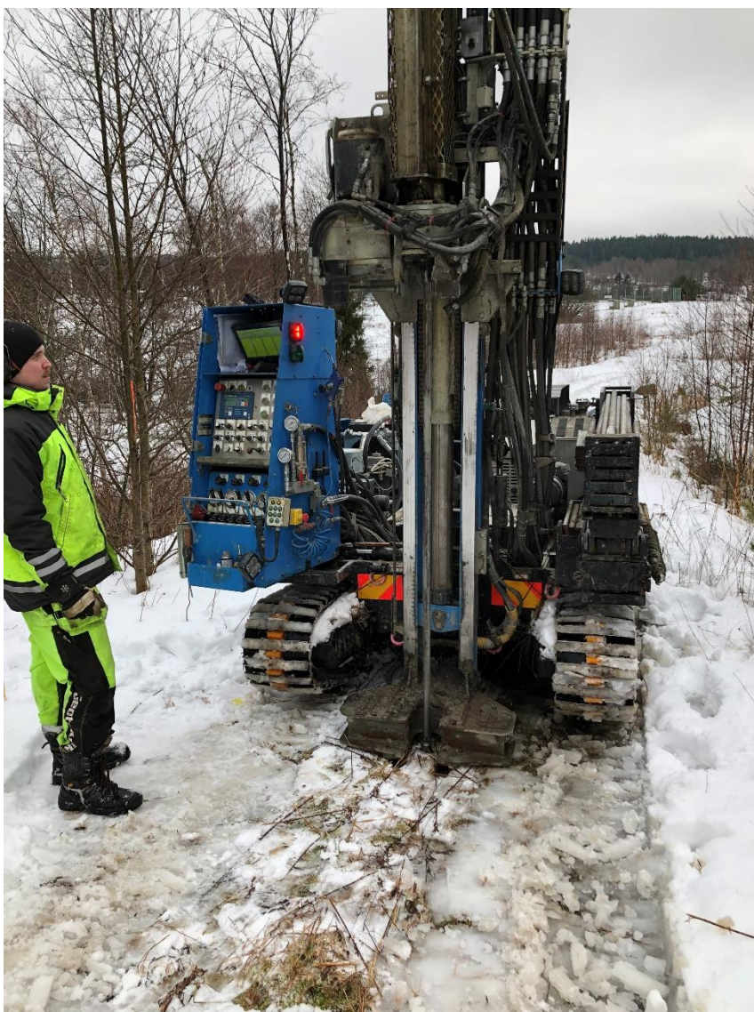
Figur 7 Borbandvagn GM 75 GT vid utförande av en trycksondering 2019-02-05.
