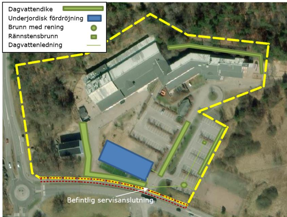
Figur 14. Schematiskt ritad föreslagen dagvattenhantering.
