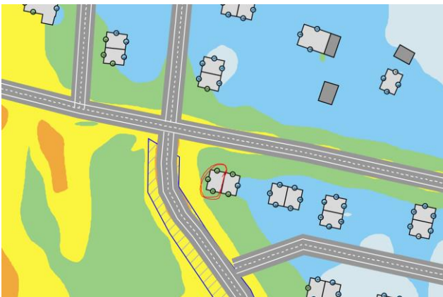
Figur 4. En bostad vid korsningen Gamla prästvågen och ny väg vid "planområde öst", där bullervillkoret för ekvivalent ljudnivå vid uteplats överskrids.
