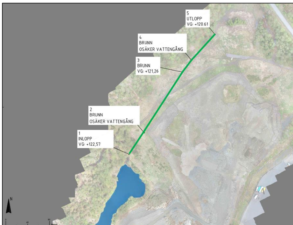
Figur 8. Illustration över läget på Sjöns utloppsledning, samt dess vattengång (VG). Tillhandahålllet av beställaren. Sjön är blåmarkerad i bildens nedre del.
