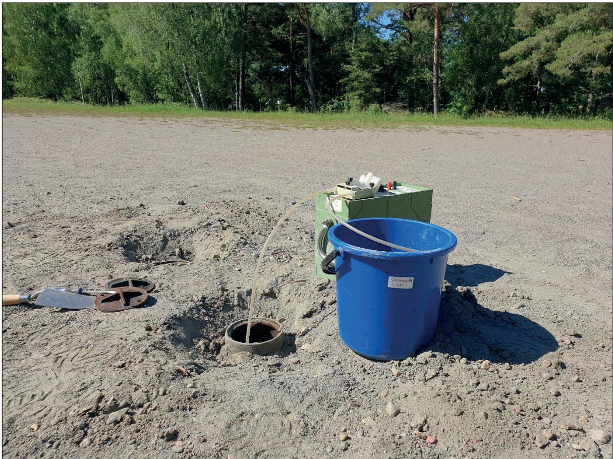
Figur 6. Provtagning av grundvatten med peristaltisk pump i provpunkt NC2007.
