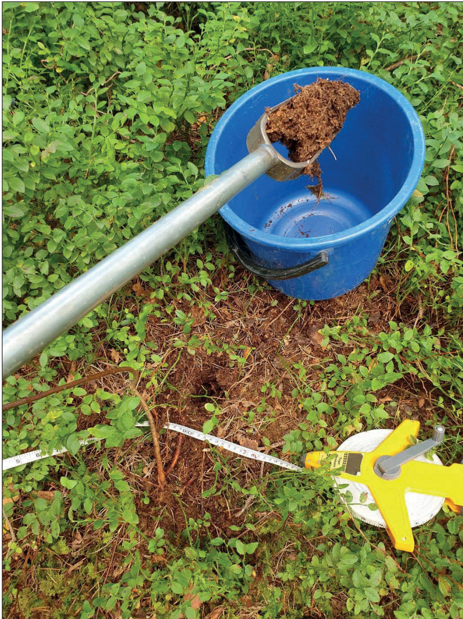
Figur 7. Jordprovtagning med manuell jordskruvprovtagare samt måttband som användes för inmätning av punkterna.
