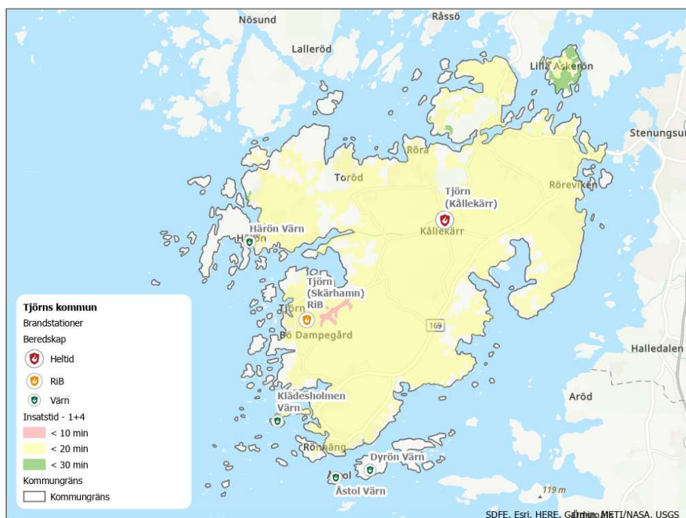
Figur 21. Insatstid 10, 20 och 30 minuter för 1+4 på skadeplats. Körtidsanalysen är skapad i ArcGIS Pro enligt ESRI:s körtidsmodell.
