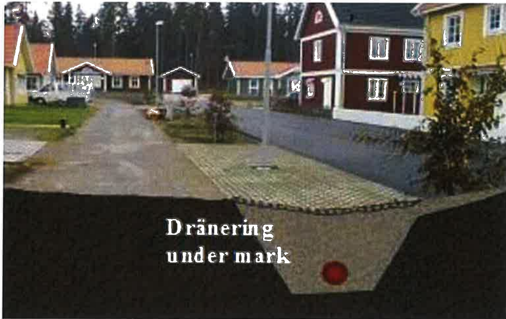
Figur 15. Makadamfyllt dike med dräneringsledning.
