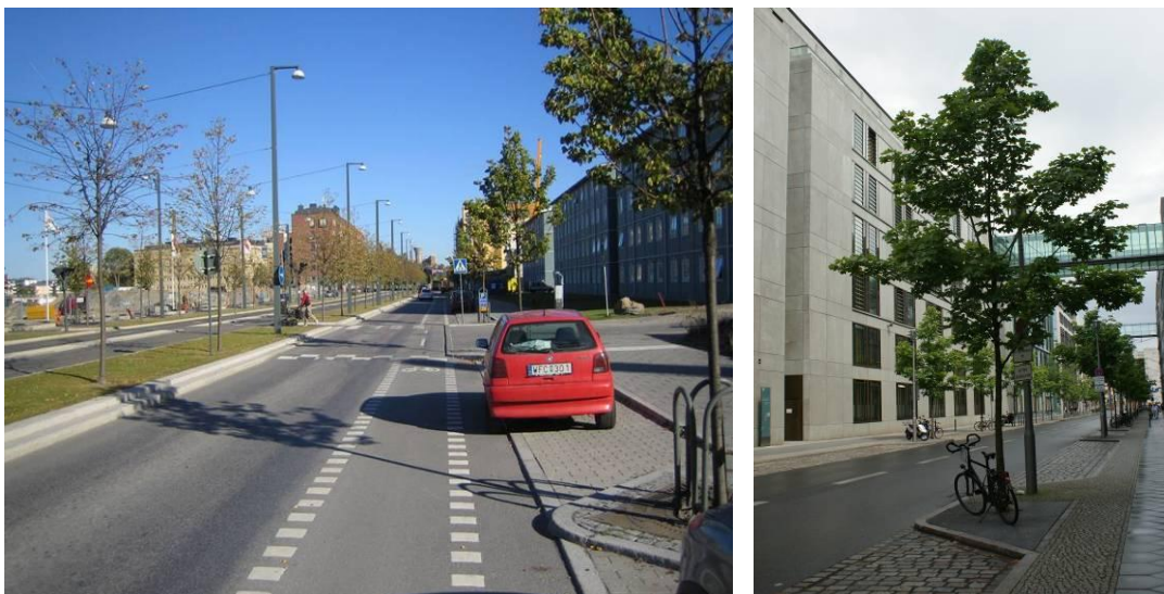
Figur 16. I den vänstra bilden visas att träden till höger, som växer i skelettjord och får dagvatten, fortfarande har gröna blad jämfört med de träd som växer till vänster som inte tillförs något dagvatten. I den högra bilden visas ett annat exempel på trädplantering i skelettjord där träden tillförs dagvatten.
