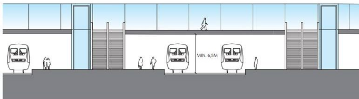
Figur 12. Gångbro över plattformsområde. Bild från Trafikverkets Stationshandbok (Publikationsnummer 2013:060).
