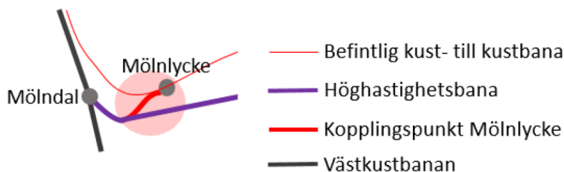
Figur 1 Illustration av hur befintlig Kust-till-kust-bana kopplas till ny stambana öster om Mölndal.
