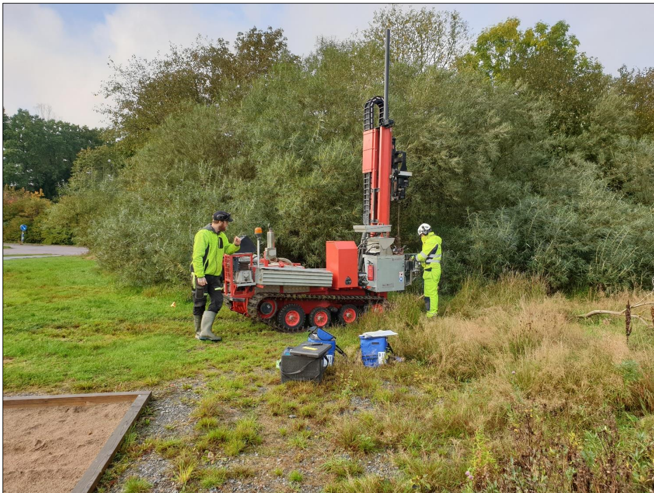
Figur 7. Jordprovtagning med borrhandsvagn. Provpunkt NC2007GV.
