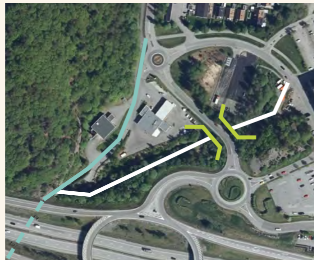
Turkos linje visar lokaliseringen av befintlig gång- och cykelbana som leder fram till tunneln under väg 40. Vit linje visar förslag på nytt stråk för främst gående längs Agnebäcken med förslag på tunnel under Härkeshultsvägen.
