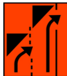
Fig 3 används då trafik leds ut till vägren
