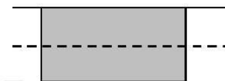
Figur 4. Illustration av fullbreddsåterställning i relation till körbanan och körfält. Om schaktåterställning är lika med eller större än 50 % av körfälts- eller körbanebredden.
