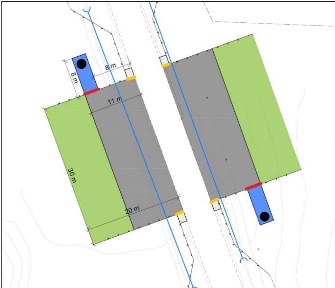
Figur 5. Utformning av viltvarningssystem. Grön yta avser röjt område och grå yta överkörningsbar del. Blå markering visar värmekamerors placering. Källa: Trafikverket, 2022
