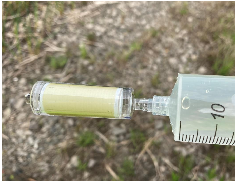
Figur 4. Filter från uttaget prov för analys av eDNA från lakvattendammen. Grön färg indikerar förekomst av fytoplankton
